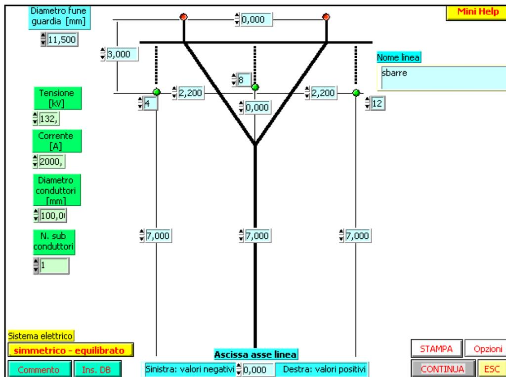
**Figura 11:** Linea AT con disposizione conduttori in piano assimilabile ad un sistema semplice sbarre a 150 kV
