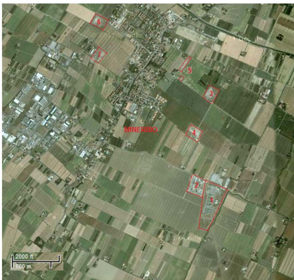
Fig. 1.1.a – Principali infrastrutture della Concessione Minerbio Stoccaggio (base: immagine satellitare Google): (1) Impianto di compressione; (2) Impianto di trattamento; (3) cluster B; (4) cluster C; (5) cluster E-E1; (6) cluster A; (7) cluster D
