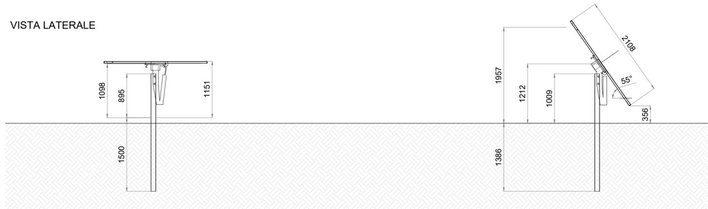
DISPOSIZIONE STRUTTURE E MODULI - PROSPETTO LATERALE
