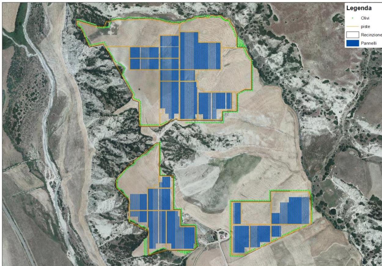
Figura 2.4 a. – Area di progetto con indicazione del posizionamento dei moduli fotovoltaici su ortofoto
