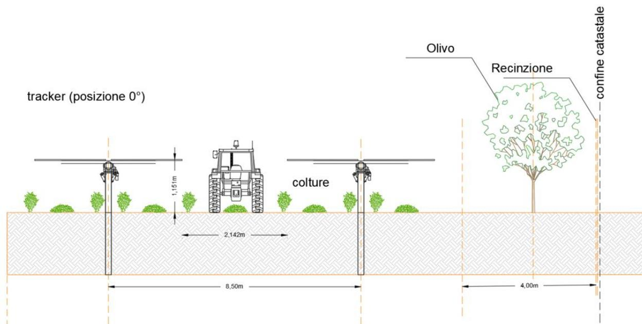
Figura 2.1. – Area di insidenza massima del modulo fotovoltaico raggiunta in posizione orizzontale.
