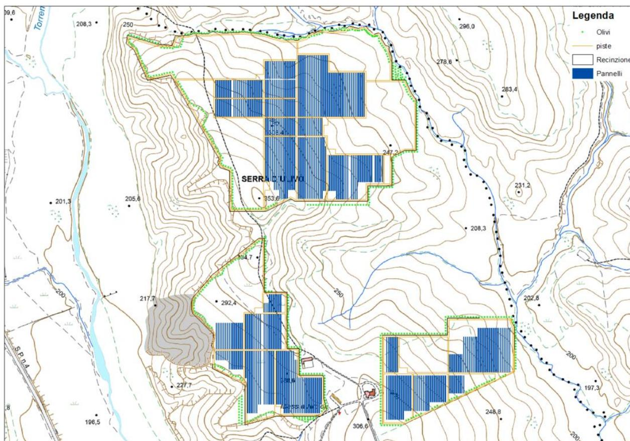
Figura 2.4 b. – Area di progetto con indicazione del posizionamento dei moduli fotovoltaici su CTR
