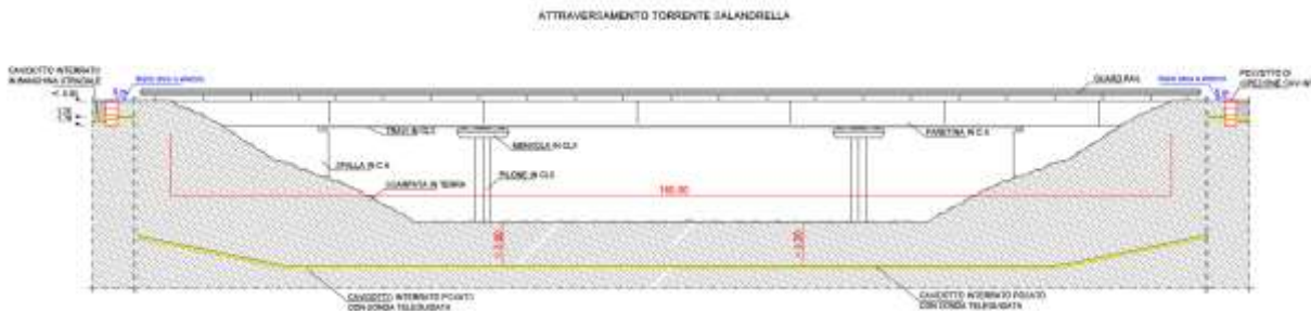
Figura 10: attraversamento in T.O.C. di progetto.
