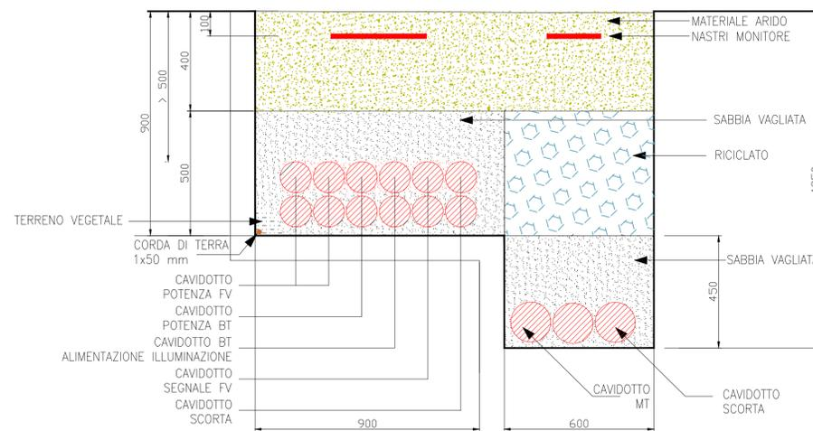
SEZIONE CAVIDOTTI BT E CORDA DI TERRA
