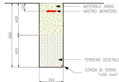
SEZIONE CAVIDOTTO BT IMPIANTO ILLUMINAZIONE E CORDA DI TERRA
