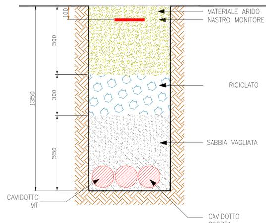
SEZIONE CAVIDOTTI MT - BT - CORDA DI TERRA
