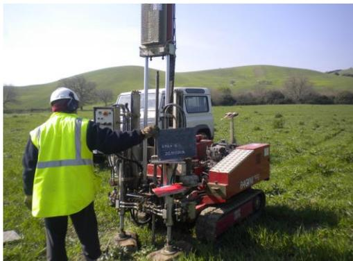
Prova penetrometrica dinamica DPSH 1
