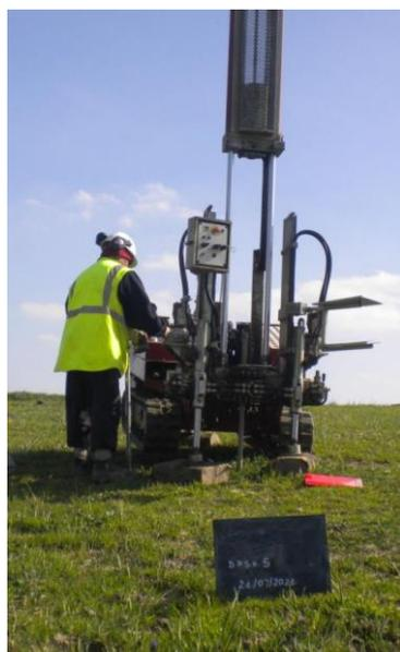
Prova penetrometrica dinamica DPSH 5
