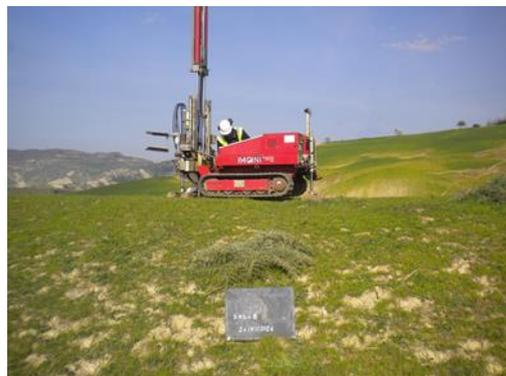
Prova penetrometrica dinamica DPSH 8
