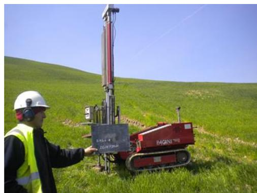
Prova penetrometrica dinamica DPSH 4
