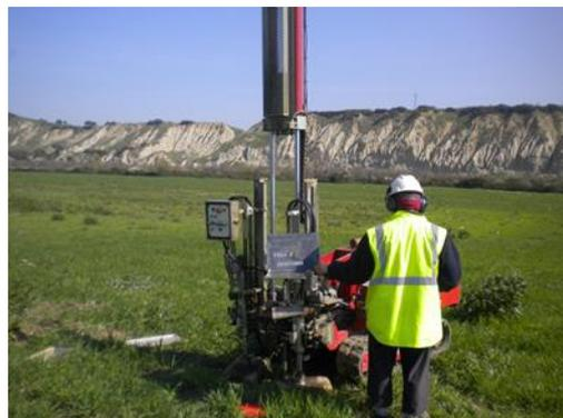
Prova penetrometrica dinamica DPSH 2
