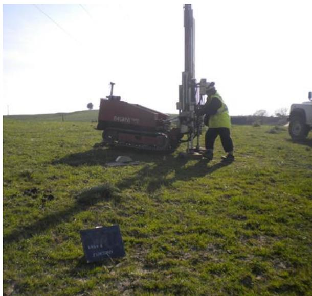
Prova penetrometrica dinamica DPSH 6
