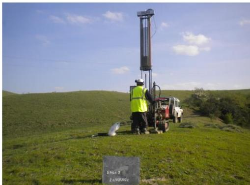
Prova penetrometrica dinamica DPSH 7
