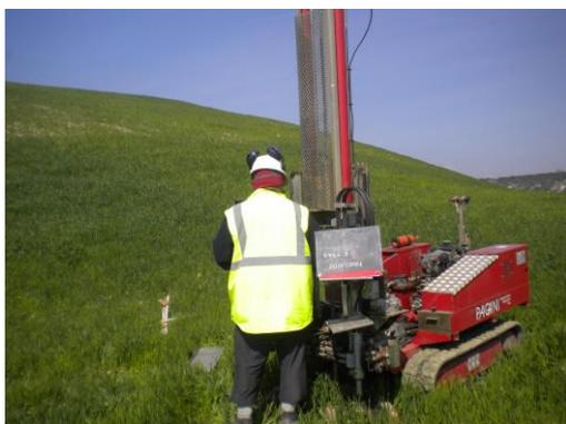
Prova penetrometrica dinamica DPSH 3
