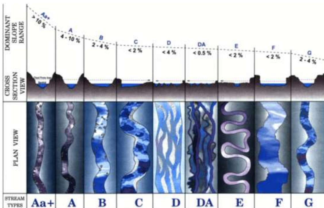
Figura 23: Relazione tra l'andamento altimetrico, planimetrico e la sezione trasversale di un corso d'acqua (da *Applied River Morphology*)
