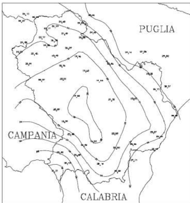
Figura 12: Isoleee del coefficiente  $a$  della curva di probabilità pluviometrica.
