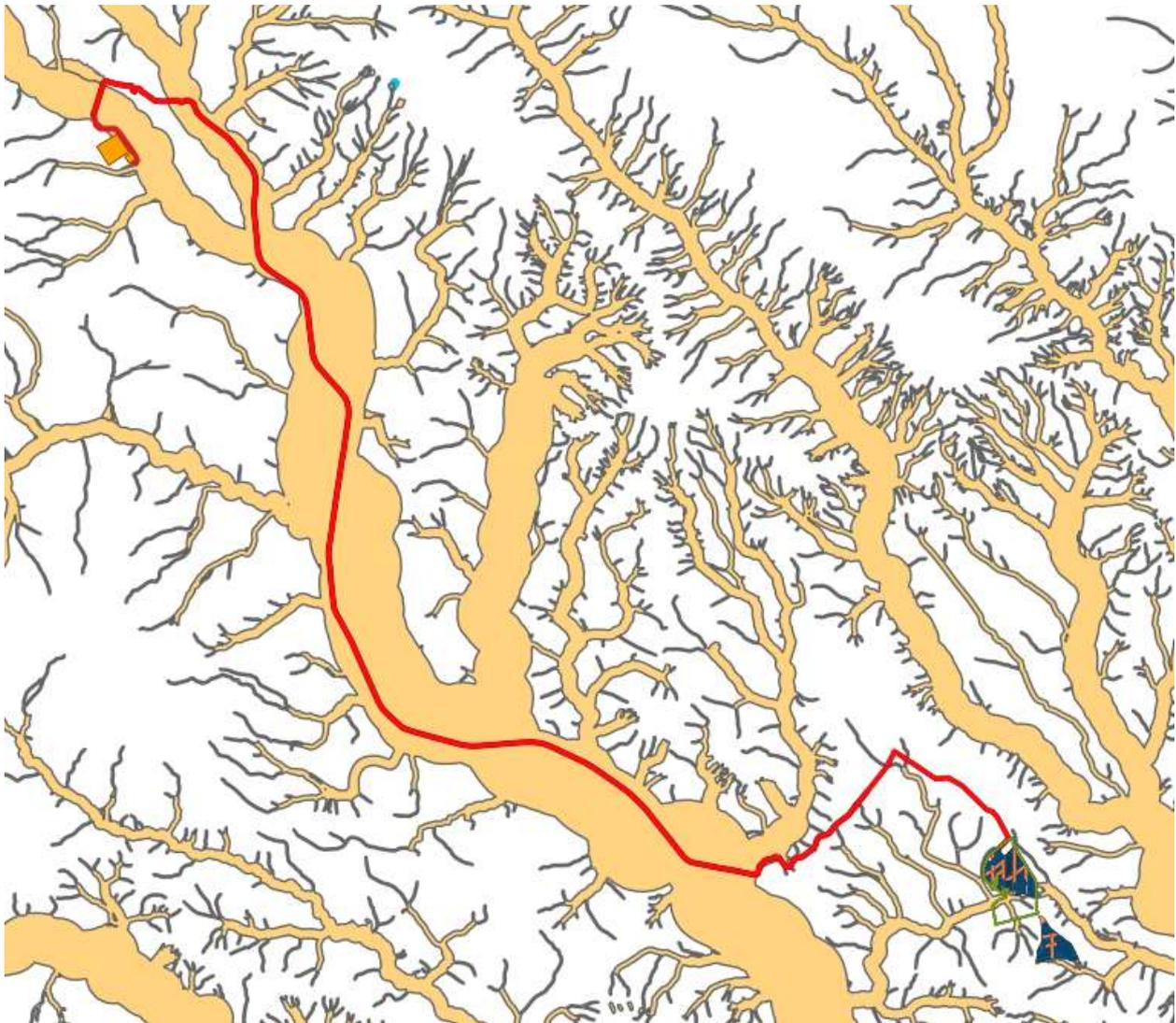
Figura 8: Interferenza dell'impianto di progetto con le aree a potenziale rischio alluvione (APFSR)
