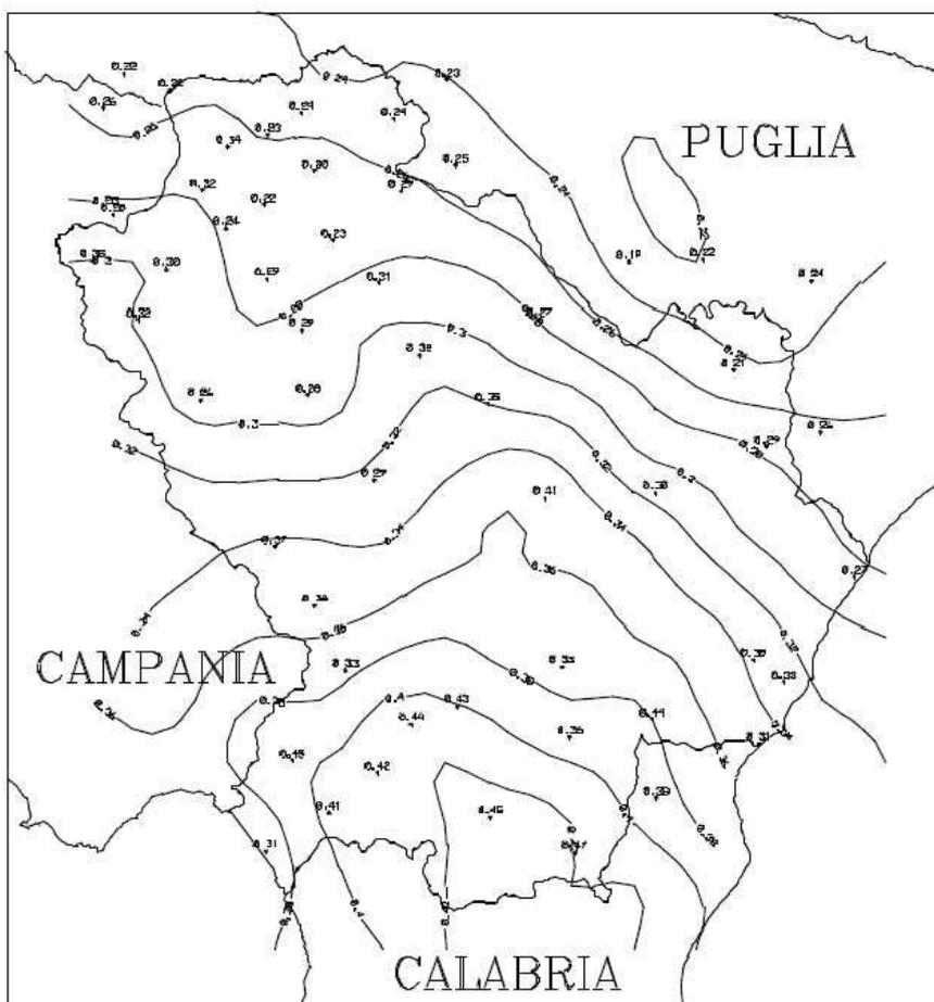
Figura 13: Isolinee dell'esponente  $n$  della curva di probabilità pluviometrica.
