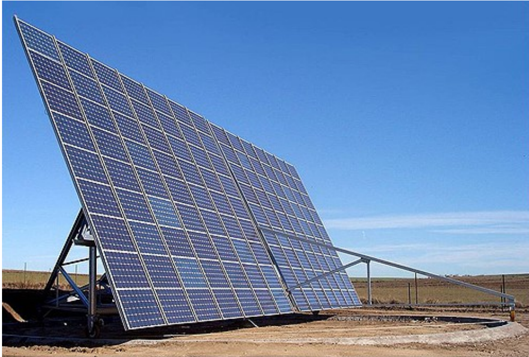
Figura 7 - Inseguitore biassiale "tilt – rollio"
