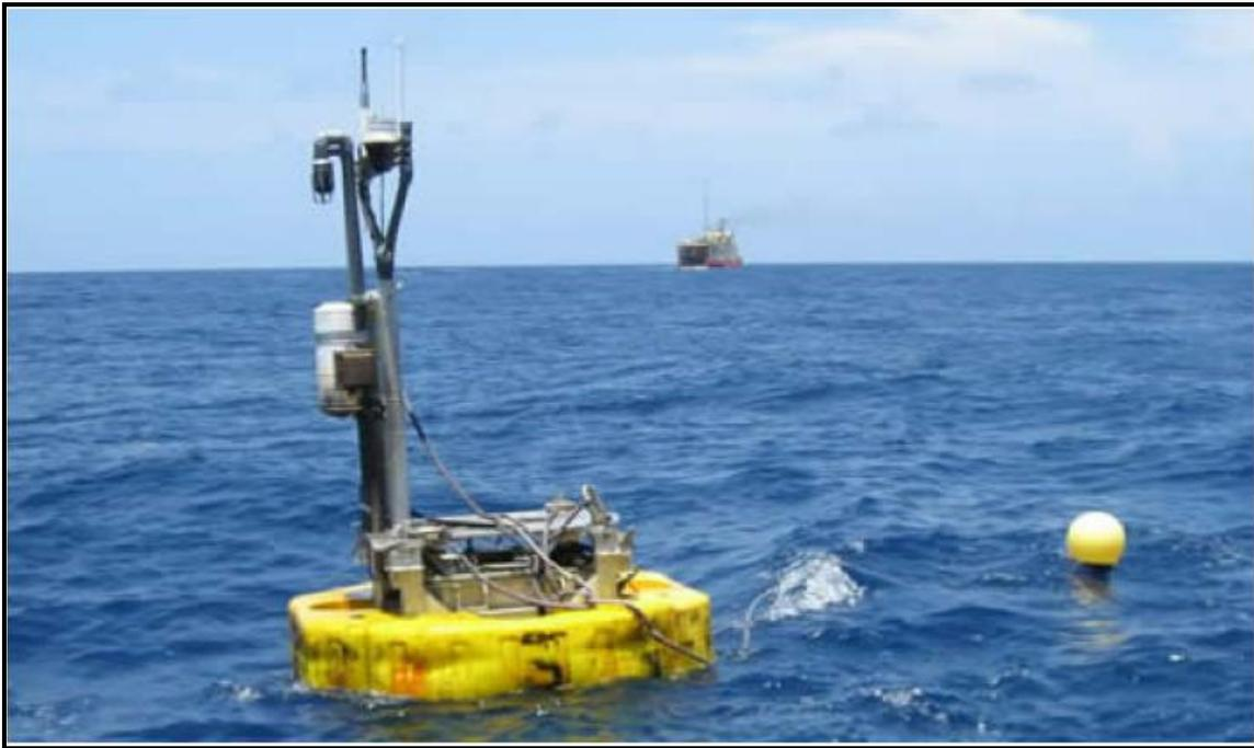
Figura 1-10: esempio di boe radio comandate
