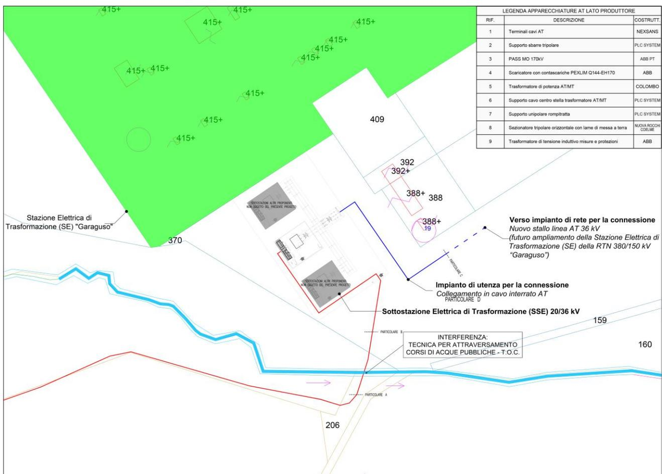
**Stralcio su base catastale della Sottostazione Elettrica di Trasformazione (SSE) del Produttore con relativa connessione AT al futuro ampliamento della Stazione Elettrica di Trasformazione (SE) “Garaguso”**
