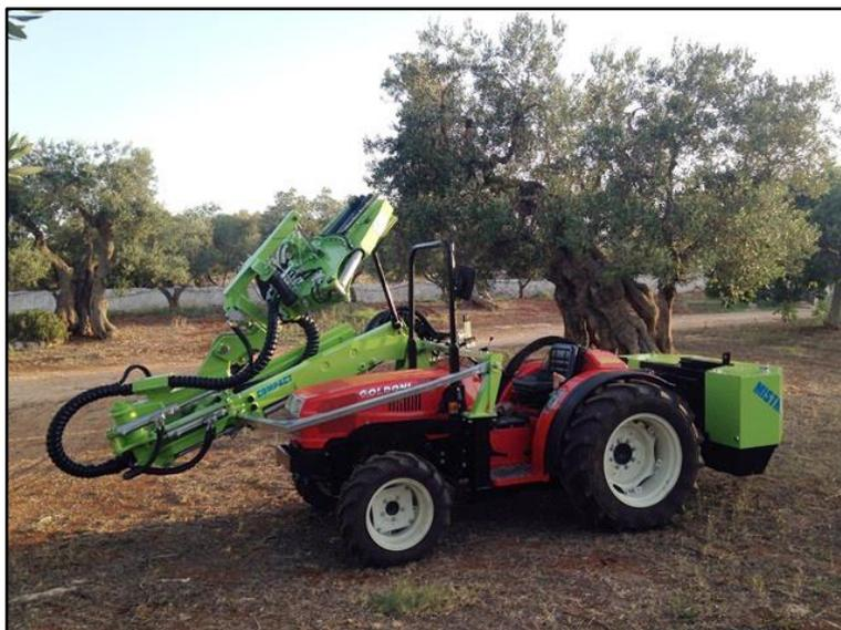
*Figura 15 – Esempio di scuotitore a braccio montato su trattore (Fonte: D’amico Office srl)*
