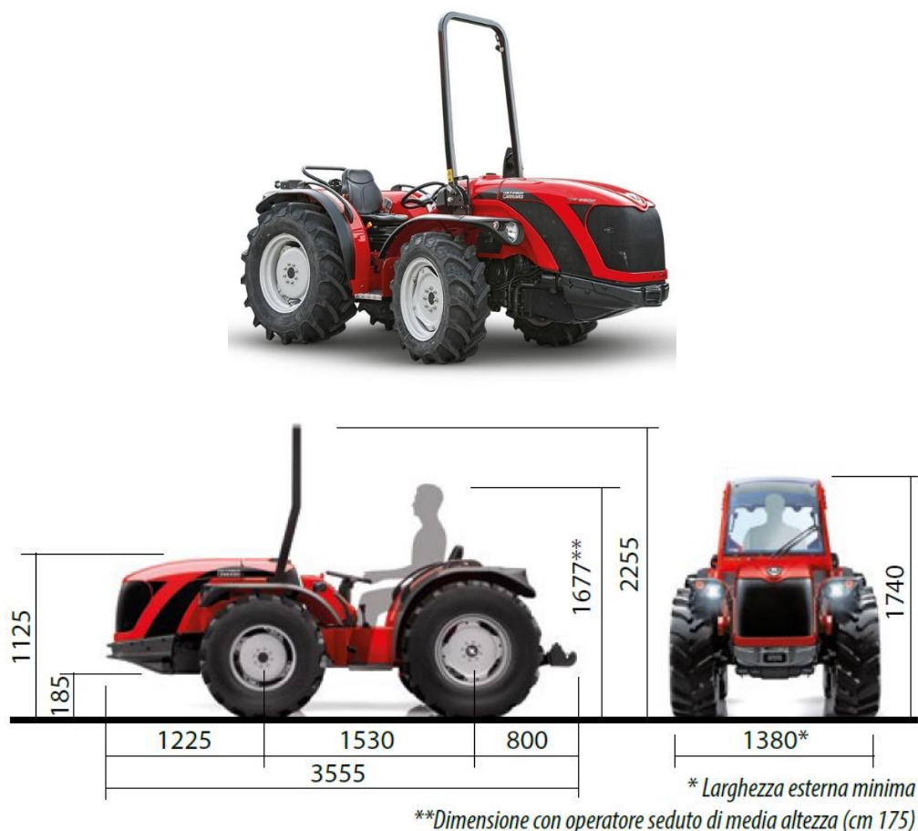
Figura 11 – Esempio di trattore da frutteto che potrà essere adoperato per le operazioni colturali Fonte: https://www.antonioarraro.it/it/catalogo/tgf
