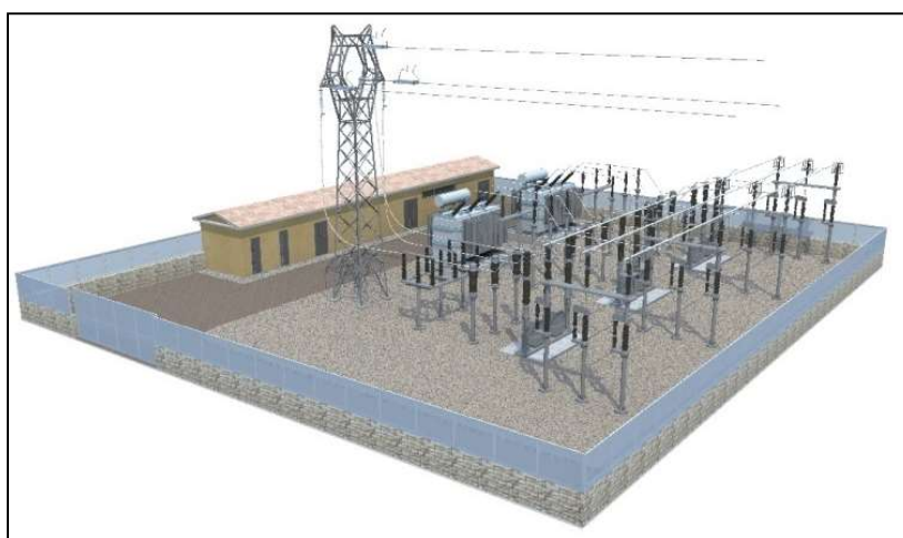
Figura 7-5 Sottostazione tipo con apparecchiatura ad alta tensione, trasformatore, quadri di media tensione e armadio di comando.
