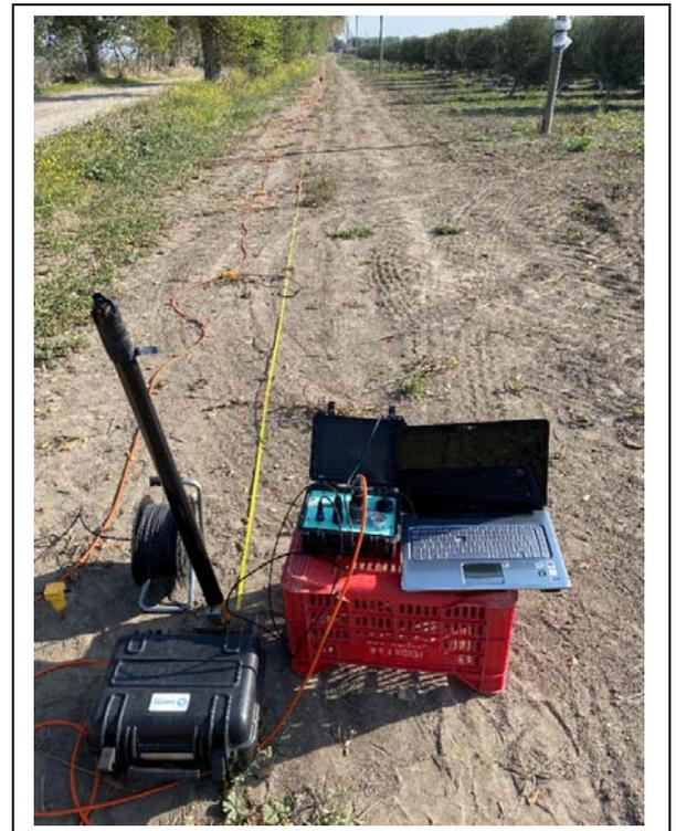
L'elaborazione del sismogramma ha consentito di estrapolare lo spettro di velocità (fig. a) dal quale si è risalito tramite picking alla curva di dispersione che consente di ottenere sia gli spessori dei vari strati che le rispettive velocità.
