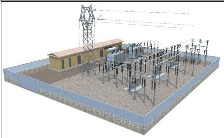
Figura 5-3 Sottostazione tipo con apparecchiatura ad alta tensione, trasformatore, quadri di media tensione e armadio di comando
