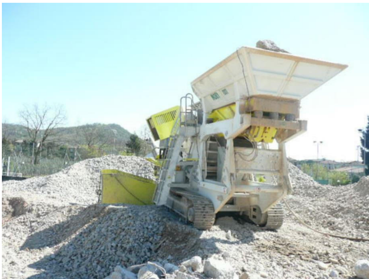
Figura 9: Esempio impianto di frantumazione mobile
