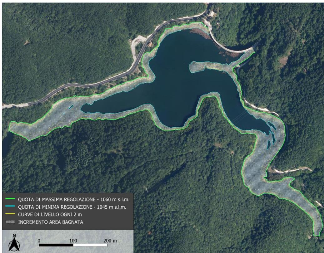
**Figura 210:** Rappresentazione su mappa della variazione di livello nel lago di Provvidenza nello stato di fatto con l'impianto di Provvidenza in funzione e l'impianto di San Giacomo fermo – **Analisi Pr.T.5**
