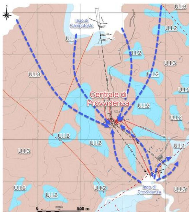
**Figura 57:** Schema delle principali direzioni di flusso indicate dalle frecce in blu
