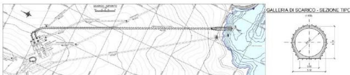
**Figura 48:** Nuova galleria di scarico/aspirazione sulla derivazione Provvidenza – pianta e sezione tipo
