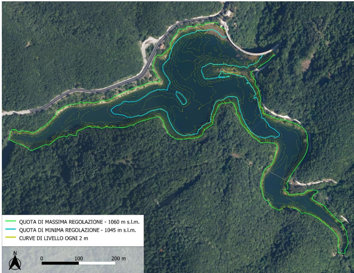
**Figura 200:** Carta batimetrica del lago di Provvidenza
