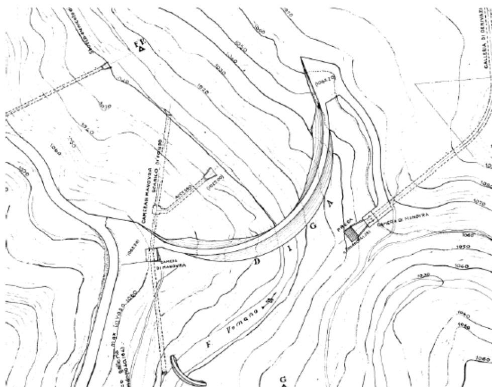
Figura 11: Diga di Provvidenza – planimetria generale
