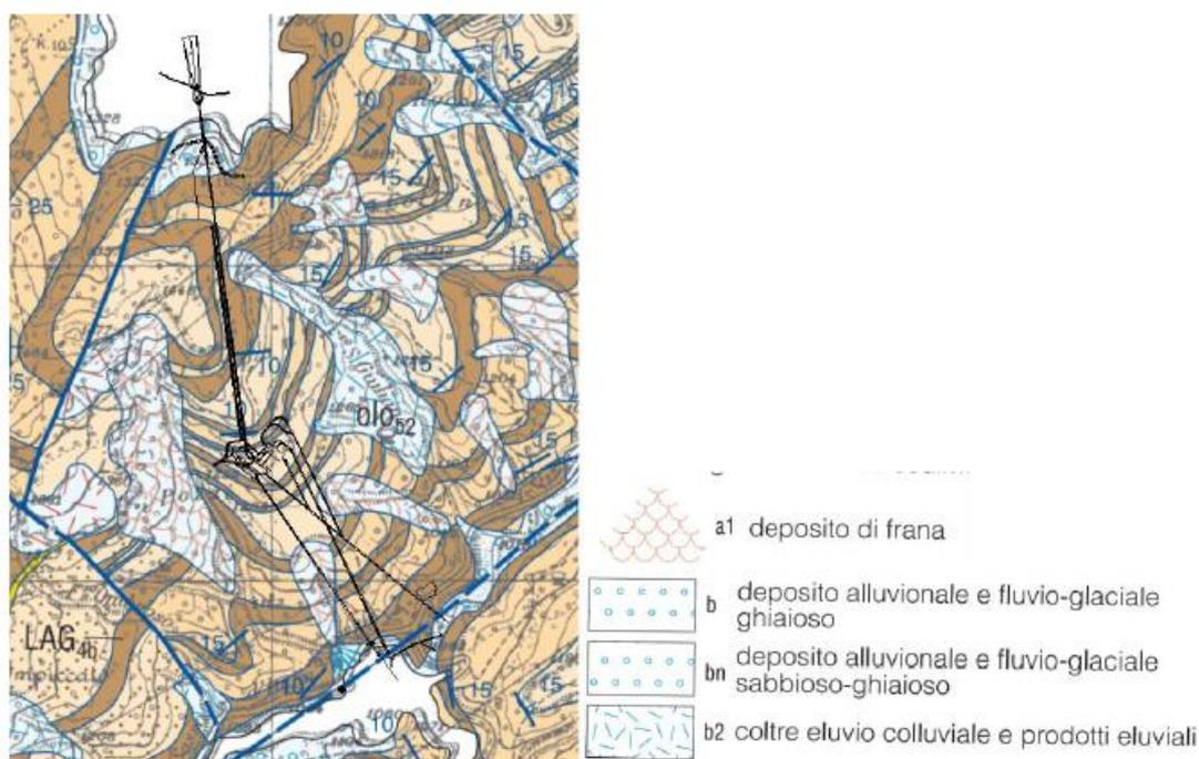
**Figura 140:** Stralcio della Carta Geologica d'Italia F.349 "Gran Sasso d'Italia". Lungo il versante in studio sono segnalate alcune frane e dei depositi eluvio-colluviali
