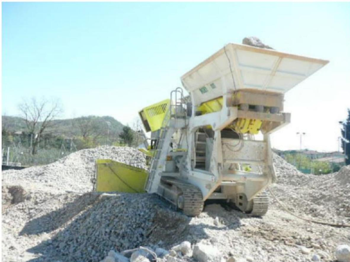
**Figura 67:** Esempio impianto di frantumazione mobile
