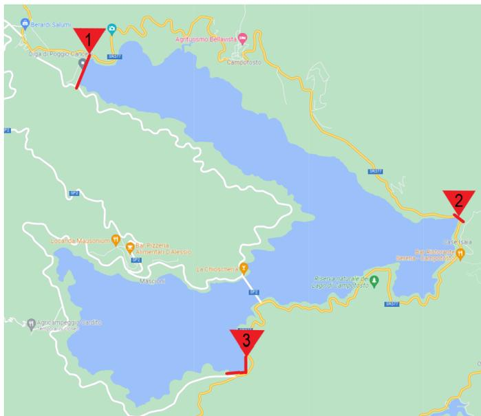
**Figura 3:** Posizione delle dighe del serbatoio di Campotosto: diga di Poggio Cancelli (1), diga di Rio Fucino (2), diga di Sella Pedinate (3)
