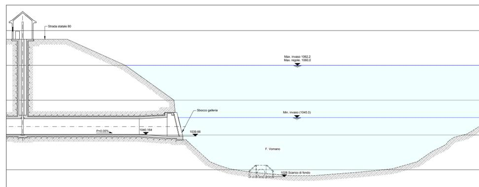
GALLERIA DI SCARICO - Sezione - stato di progetto
