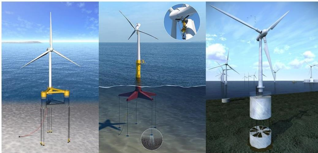
Figura 5 - Tipologia di FOWT stabilizzato con ormeggi. Immagine a sinistra: TLP conceptual scheme [16]. Immagine centrale: PelaStar TLP [17]; Immagine a destra: Eco TLP [18].
