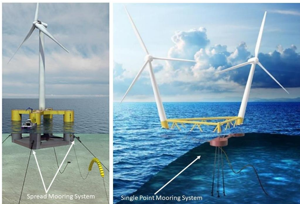
Figura 11 - Classificazione dei sistemi di ormeggio in base alla geometria. Immagine a sinistra: Ormeggio di tipo Spread generalmente applicato nelle FOWT di tipo Spar e Semi-Submersible. Immagine a destra: sistema Single-Point applicato nel concept X1Wind [27].
