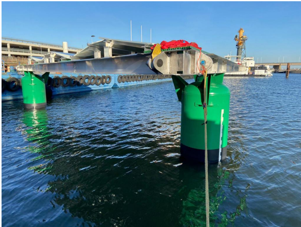
Figura 20 - Esempio di piattaforma triangolare galleggiante per la produzione di energia fotovoltaica (Fonte: https://solarduck.tech )
