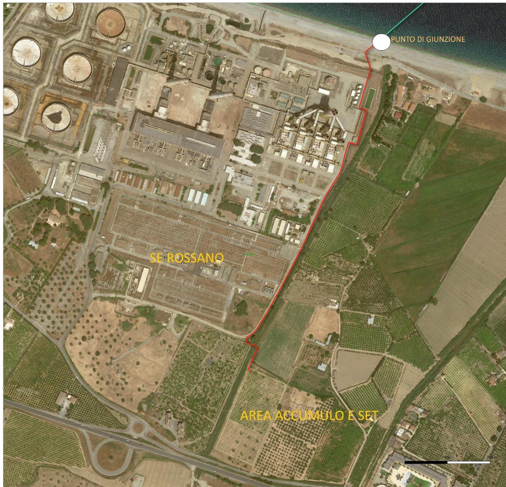
Figura 26 - Ipotesi di percorso cavidotto terrestre interrato
