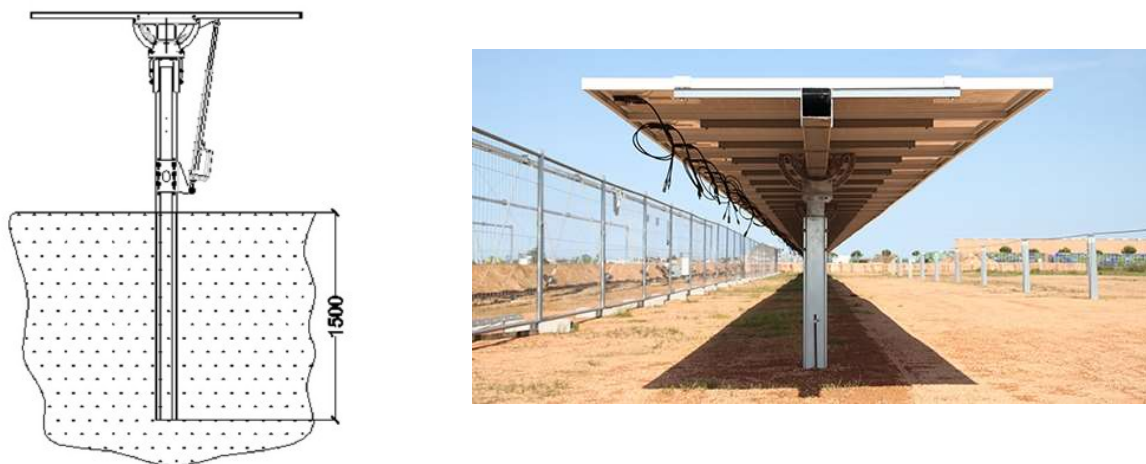
Fig. 5 - Palo del tracker infisso nel terreno
