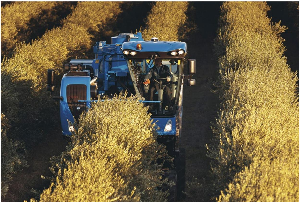
Tipologia di impianto superintensivo con macchina scavallatrice
