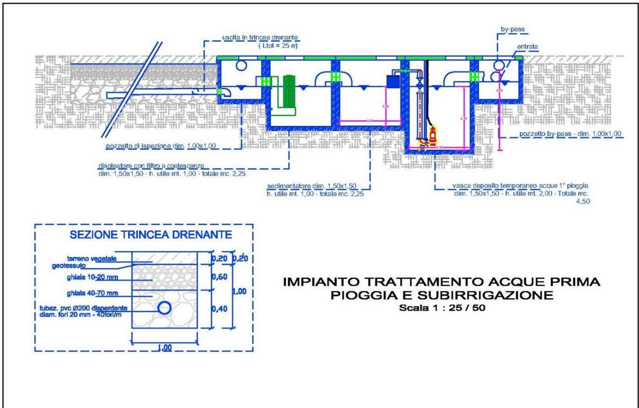
I dissabbiatori/disoleatori per acque reflue di piazzale, sono sistemi di disoleazione a gravità che permettono il trattamento e la separazione degli oli /idrocarburi non emulsionati (e con peso specifico  $<0,85$  g/cm<sup>3</sup>) dalle acque di scarico in genere , attraverso una separazione statica.
