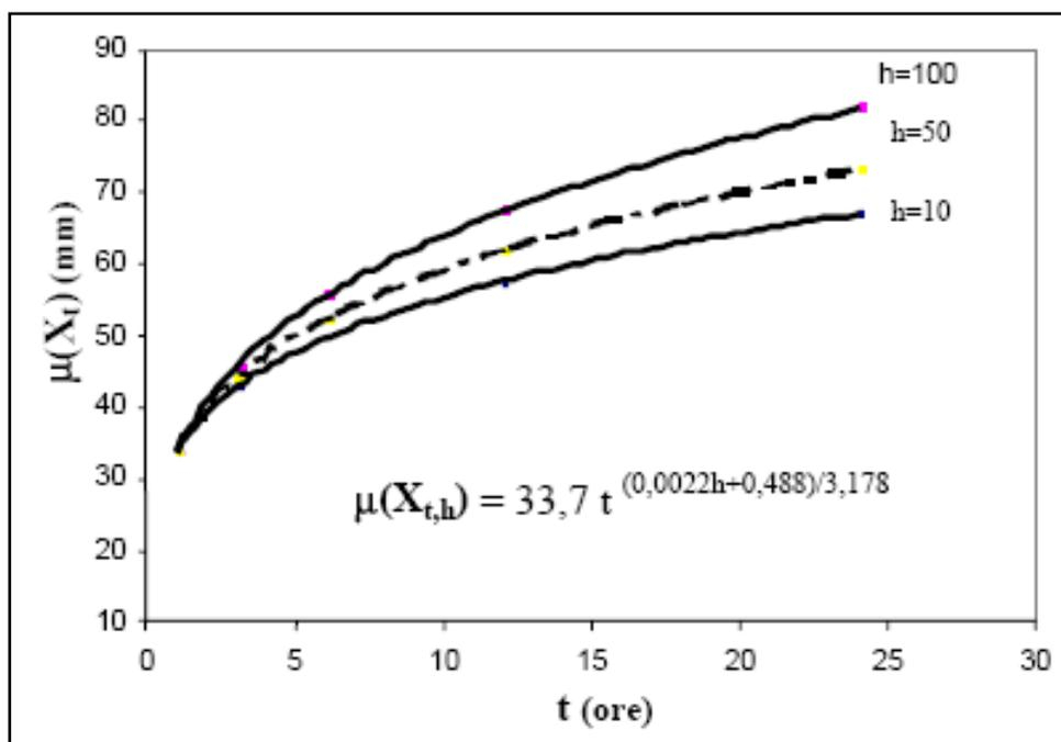
Figura 13. Curva di probabilità pluviometrica, Zona 6 (Penisola salentina).
