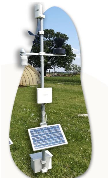
Il Sistema di acquisizione dati usato per il presente impianto è un Sistema già brevettato in uso in varie aziende Agricole denominato BLULEAF.
