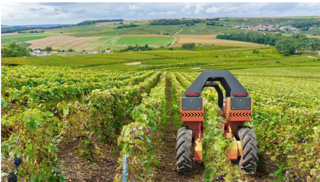
Immagine tratta dalla rivista "flashbattery.tech"-Scavallatrice elettrica robotizzata.
