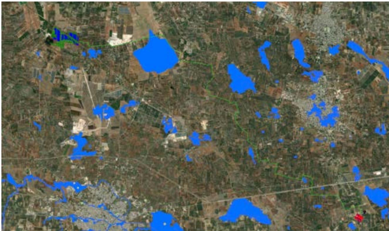
**Cavidotto (in verde) e aree a pericolosità idraulica AP (blu)**
