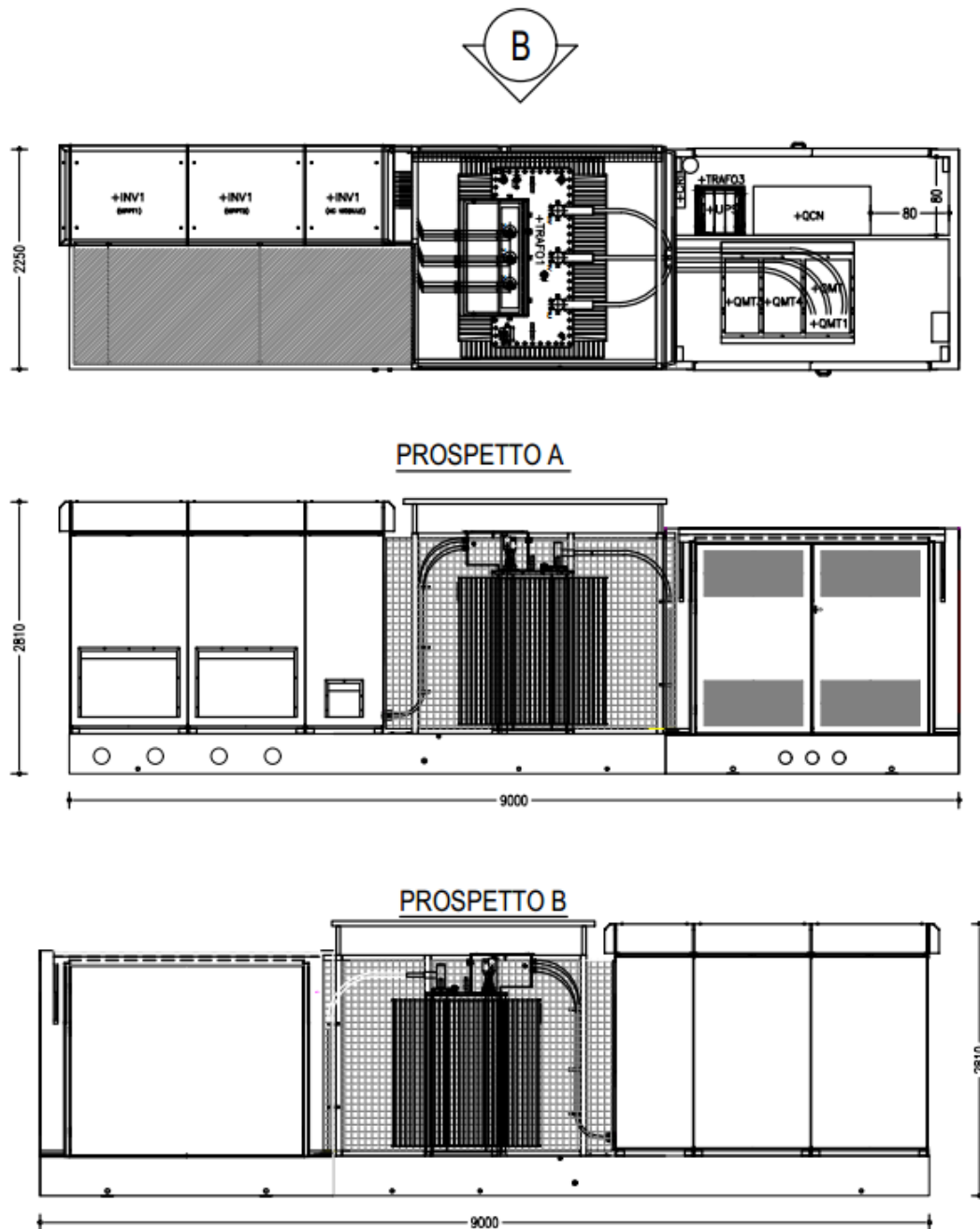
Figura 29:Pianta e Prospetti apparati di trasformazione.
