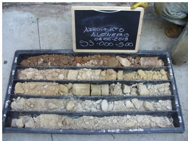
Le carote estratte nel sondaggio S3
