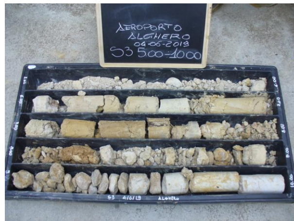
Le carote estratte nel sondaggio S3
