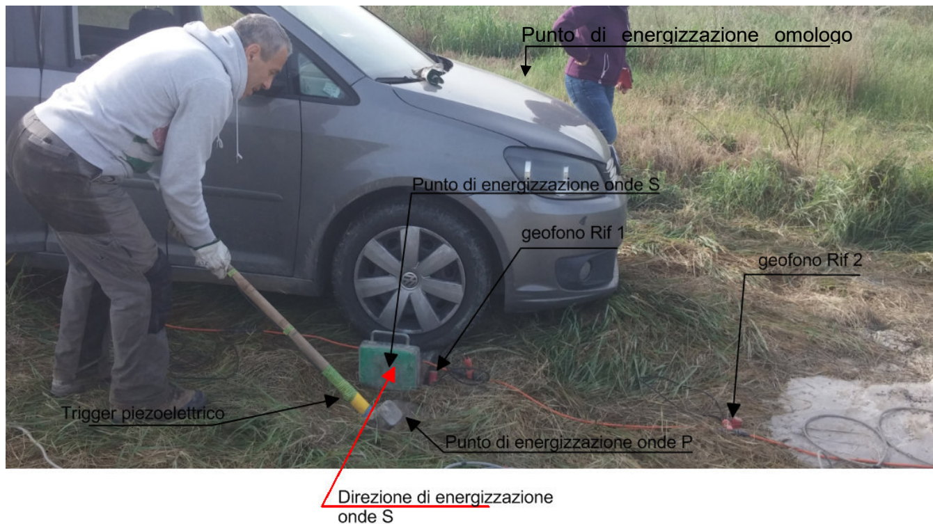
Figura 7.1 Immagine degli apparati di energizzazione
