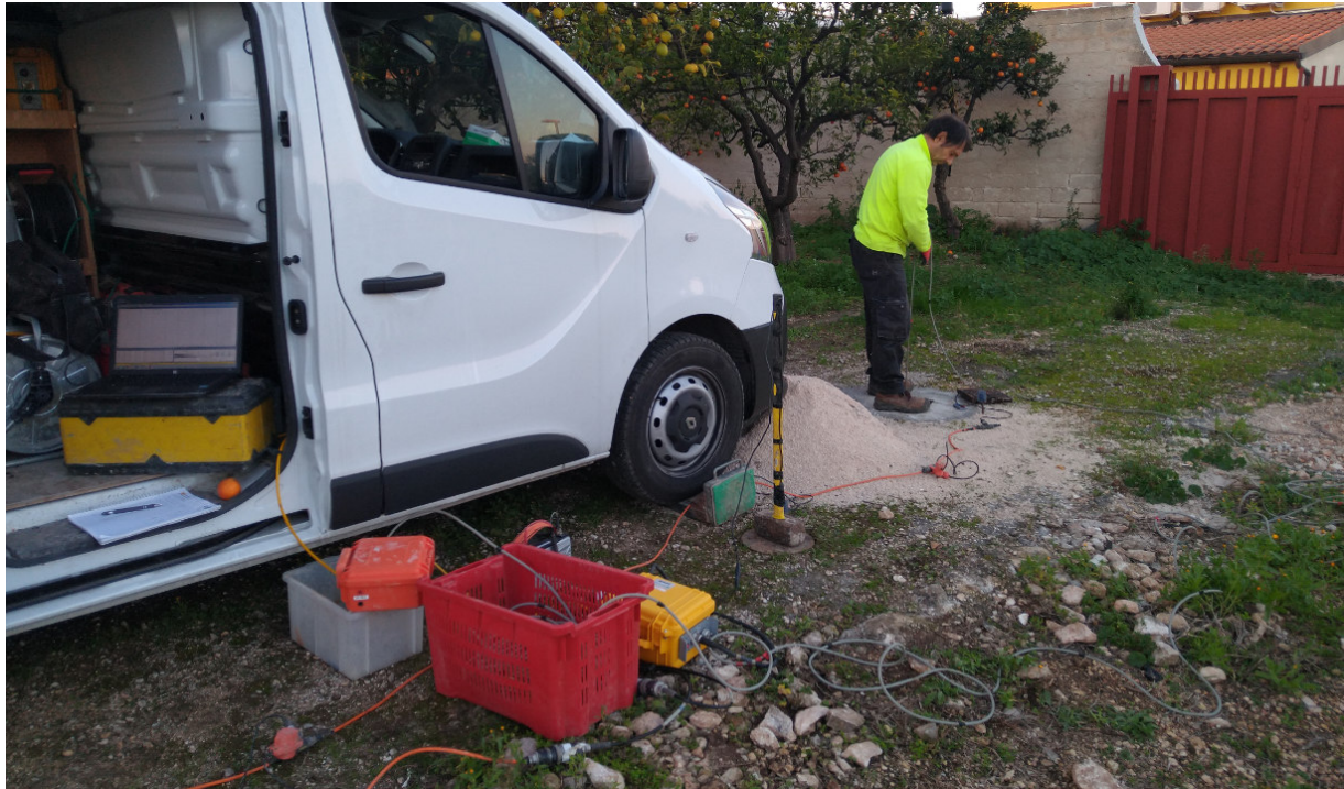
Particolare indagini in foro Down Hole GA05
