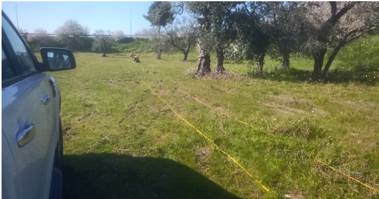
Particolare indagini elettrica tomografica TE8
