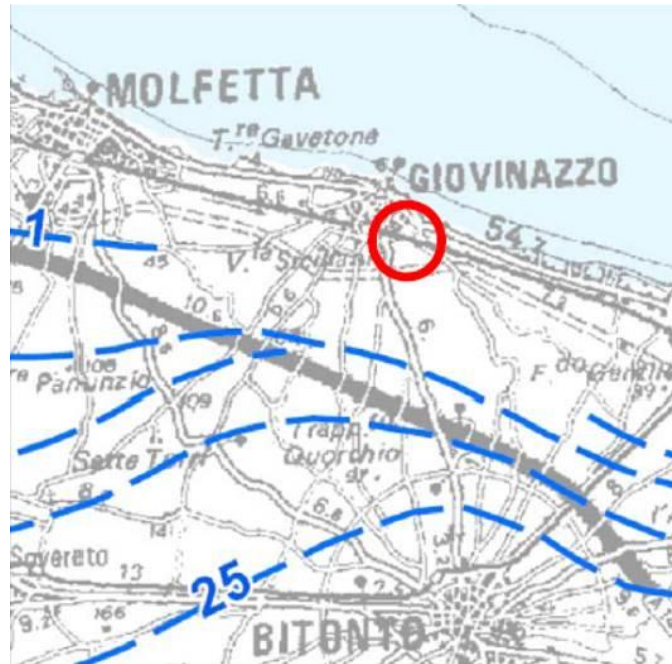
Figura 4-7 Andamento delle linee piezometriche (Fonte: Piano Indagini della “Bonifica ed il ripristino ambientale delle ex Acciaierie e Ferriere Pugliesi in area Lama Castello – Progetto esecutivo lotto II”)
