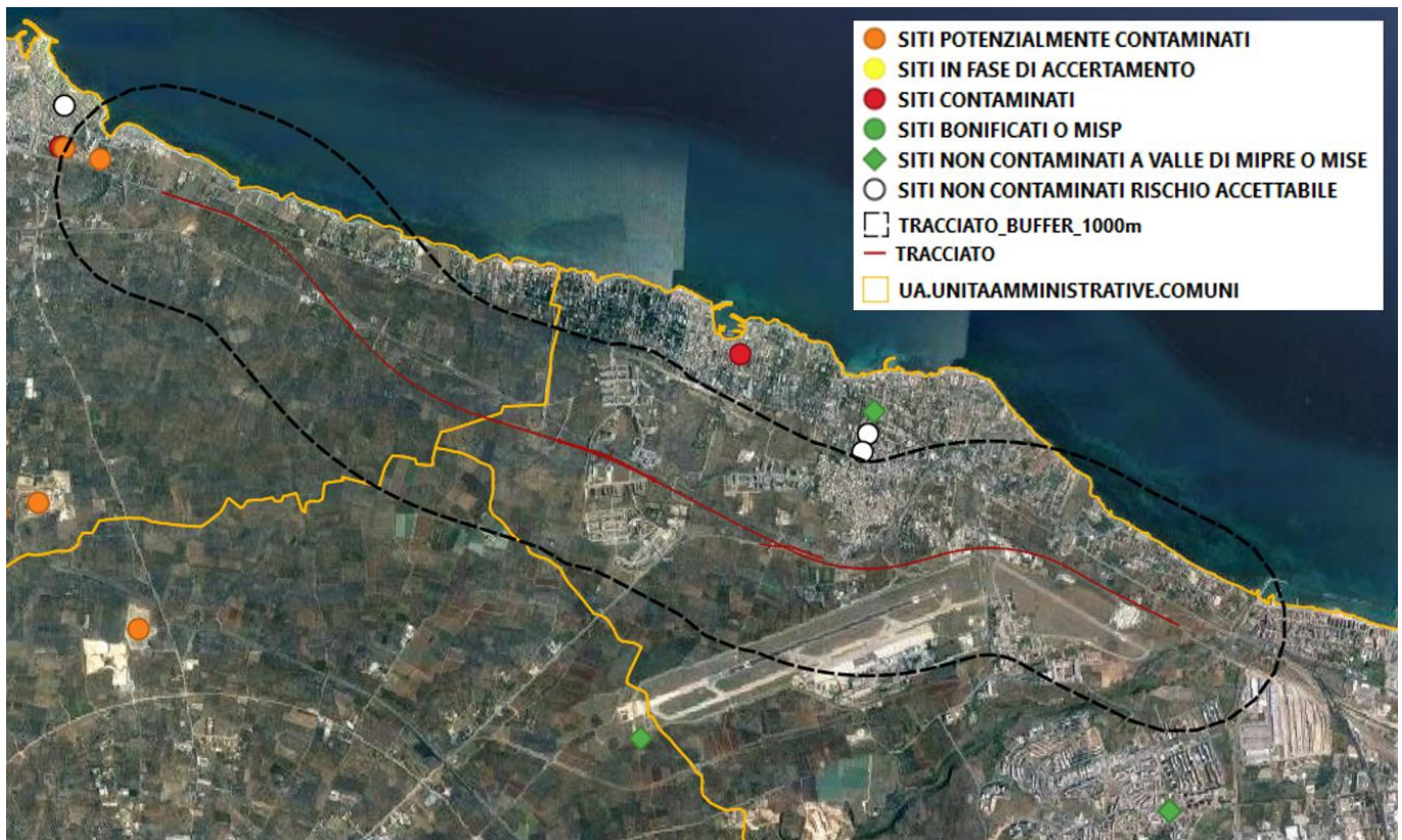
Figura 6-1 Localizzazione dei siti appartenenti all'Anagrafe della Regione Puglia rispetto al tracciato ferroviario
