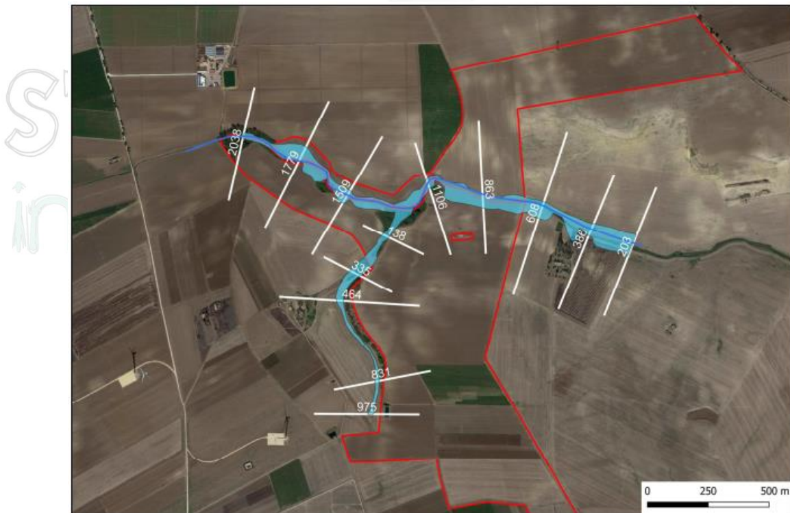
Figura 2-9: Simulazione Idraulica con TR=200 anni
