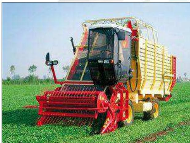
Fig.15 - Sistema di raccolta meccanizzato dello spinacio in pieno campo, vista laterale
