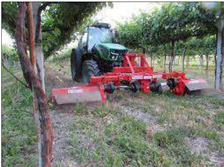
Figura 1 - Esempio di lavorazione con fresatrice bilaterale intercetto
