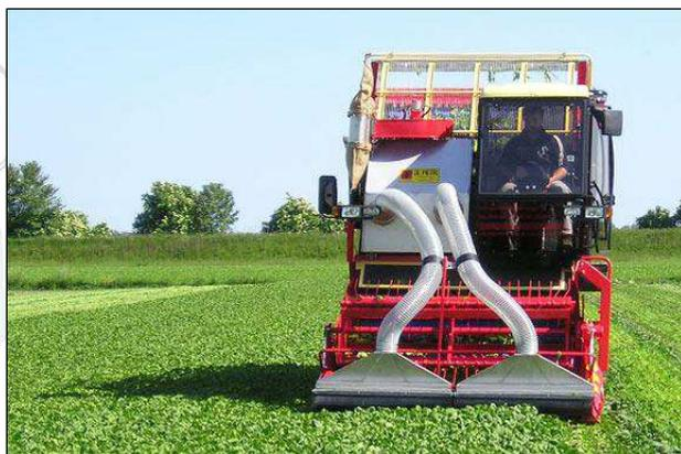
Fig.16 - Sistema di raccolta meccanizzato dello spinacio in pieno campo, vista frontale
