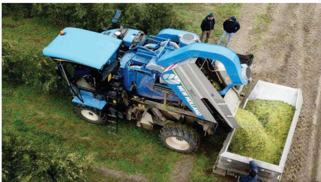
Figura 5 - Esempio di macchina scavallatrice durante la fase di raccolta
