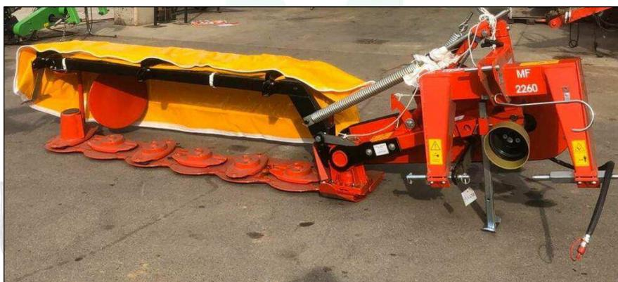
Figura 2 - Macchina operatrice falciatrice combinata a dischi.
