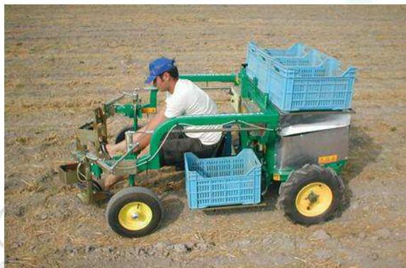
Fig.19 - Macchina agevolatrice per la raccolta
