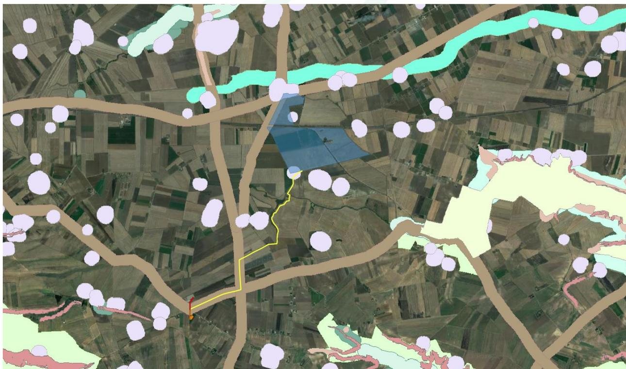
Figura 4-8: Individuazione delle aree non idonee, in blu le aree di impianto, in giallo e rosso il tracciato della connessione
