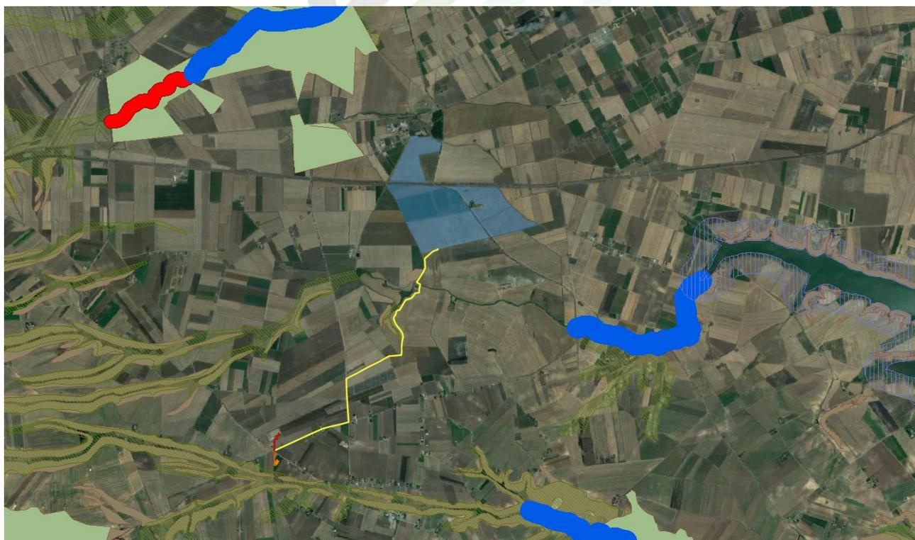
Figura 5-1: Interferenza progetto - struttura idro-geomorfologica PPTR, in blu la perimetrazione del sito, in giallo e in rosso il tracciato della connessione
