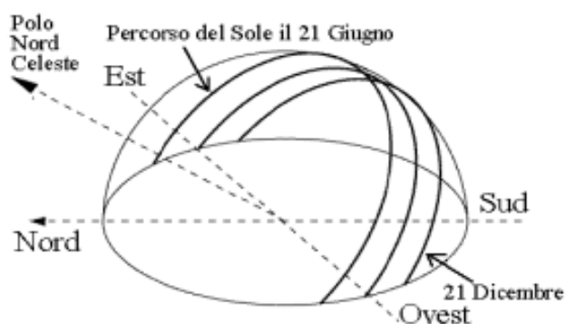
Figura 5 - Movimento apparente del disco solare per un osservatore situato ad una latitudine nord attorno ai 45°. Per tutte le località situate tra il Tropico del Cancro e il Polo Nord Geografico il disco solare non raggiunge mai lo zenit.
