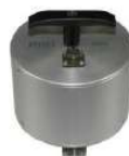
Sensore sismico 3D da superficie, frequenza geofoni 2 hz, contenitore in alluminio, piedini di supporto per utilizzo su pavimentazione o infissione nel terreno, bolla di livellamento, maniglia di trasporto.
