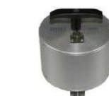
Sensore sismico 3D da superficie, frequenza geofoni 2 hz, contenitore in alluminio, piedini di supporto per utilizzo su pavimentazione o infissione nel terreno, bolla di livellamento, maniglia di trasporto.
