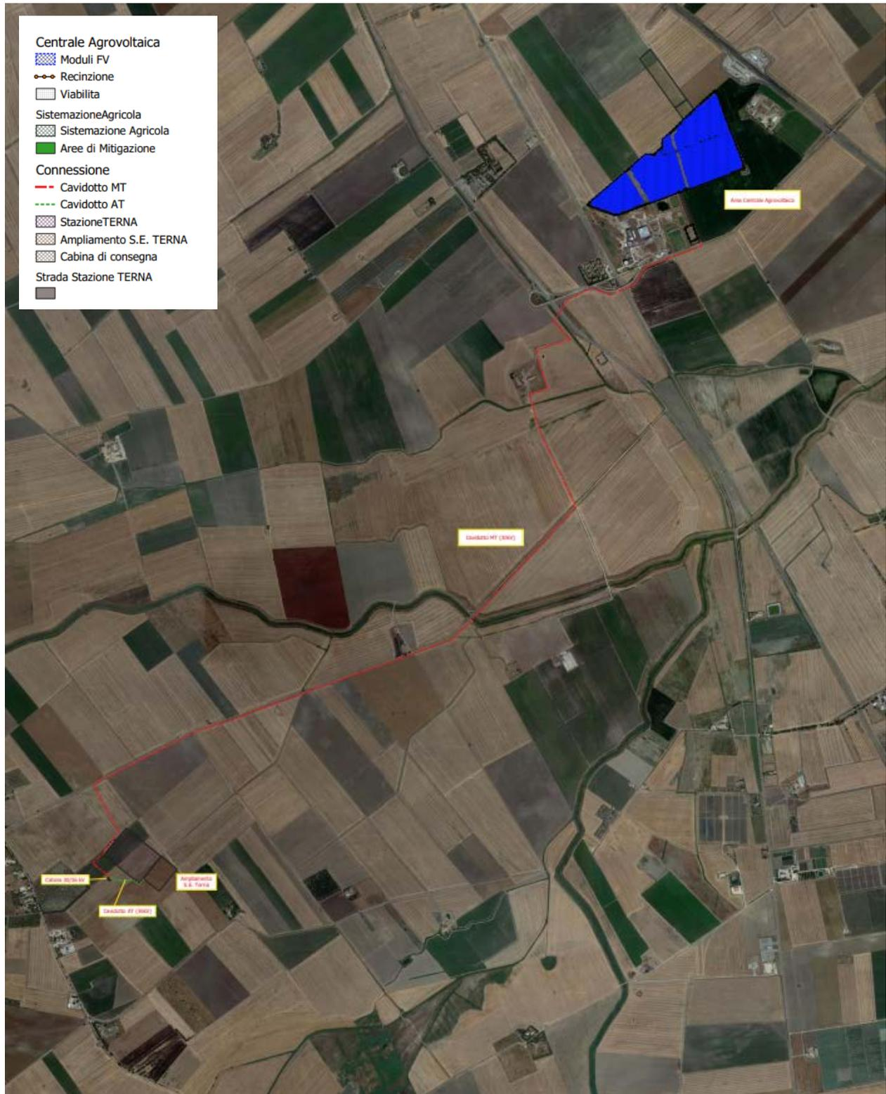
Ortofoto con l'indicazione dell'area interessata dall'impianto agrovoltaico, dal cavidotto MT di collegamento e della sottostazione 30/36 kV.
