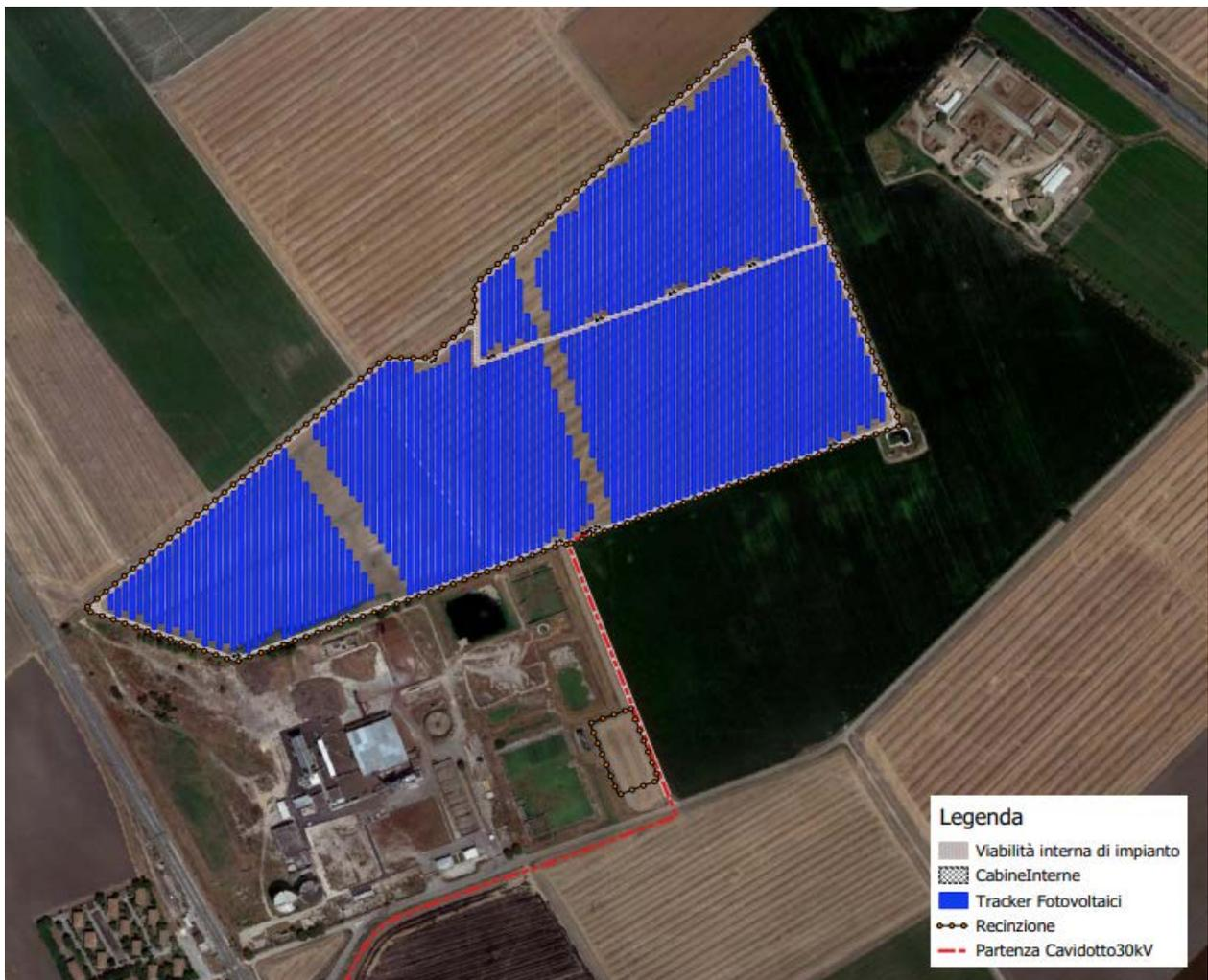
*Layout della sistemazione finale del sito: elementi della centrale fotovoltaica*
