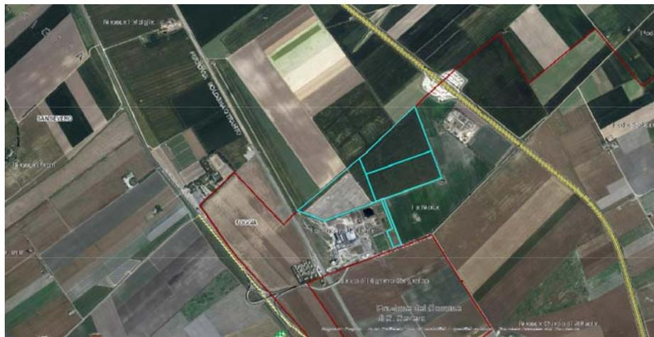
In riferimento al percorso di collegamento alla sottostazione 30/36kV, il cavidotto sarà interrato alla profondità di 1,20-1,50m. Lungo il suo tracciato affiancherà per 900m il trattorello Motta Villanova e attraverserà trasversalmente il tratturo regio Aquila – Foggia.
