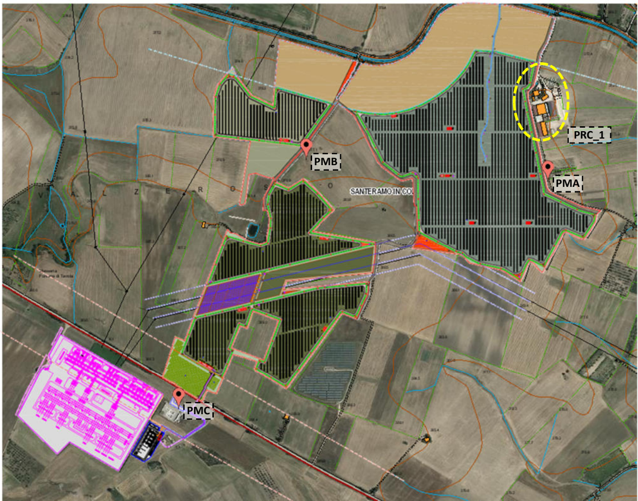
Fig. 4:: Individuazione dell'impianto su ortofoto e CTR con indicazione delle cabine inverter e trasformatore più prossime al ricettore PRC_1 e dei punti di misura ante operam (PM1, PM2 e PM3)
