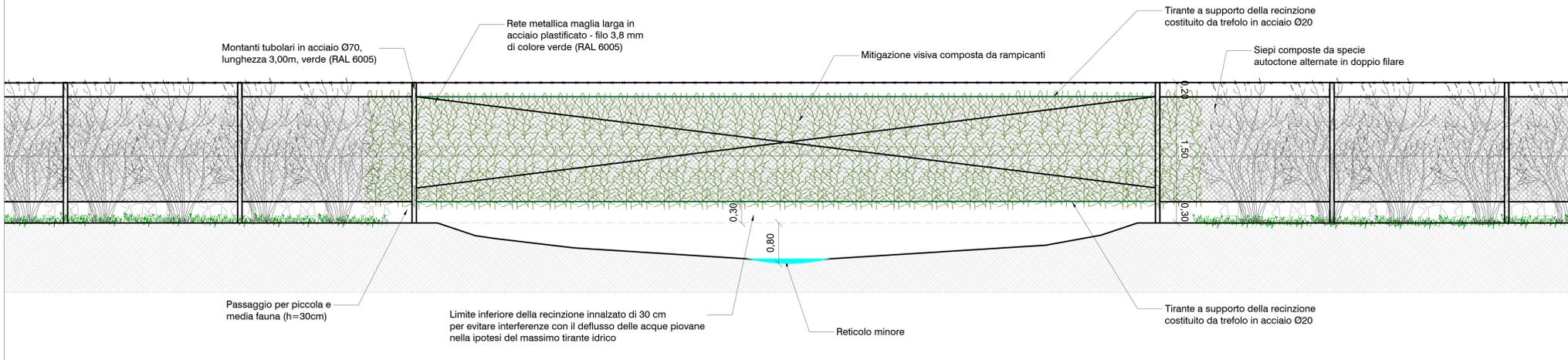
2 - PARTICOLARE CAVIDOTTO BT - ATTRAVERSAMENTO RETICOLO MINORE - Scala 1:25
