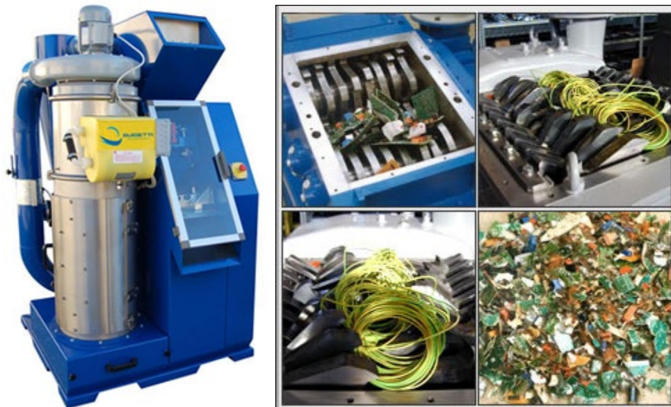
Figura 30. Macchinario per lo smaltimento delle apparecchiature elettroniche.
