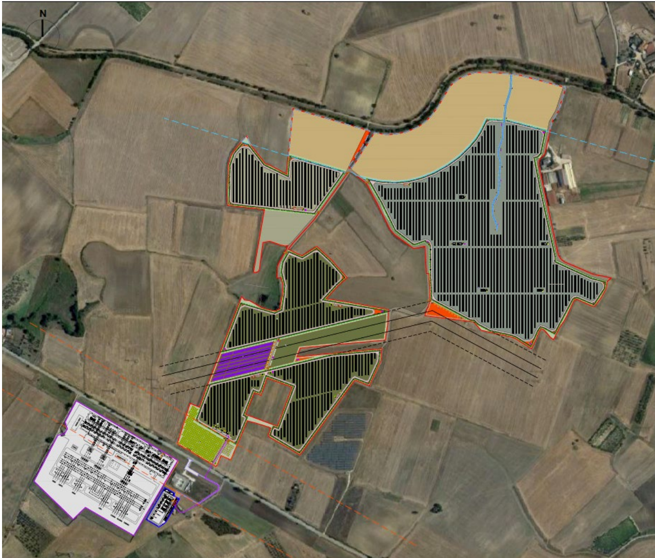
Figura 1. Layout progetto impianto agrovoltaico su base ortofoto
