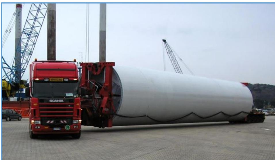
*Figura 6: Semirimorchio senza trave ad altezza del carico regolabile*
