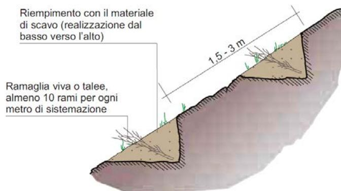
Figura 4: Sezione schematica di gradonata con talee
