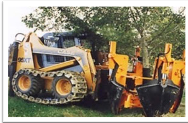
Figura 1 - Esempio di mezzi utilizzati per le operazioni di espianto
