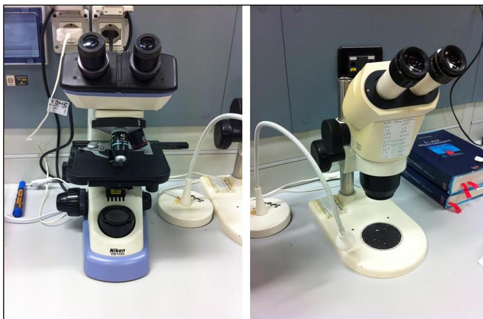
**Figura 6 - Microscopio Nikon YS100 (a sinistra) e microscopio stereoscopico binoculare 50X Zeiss Stemi 2000 (a destra) utilizzati per l'analisi della macrofauna bentonica.**
