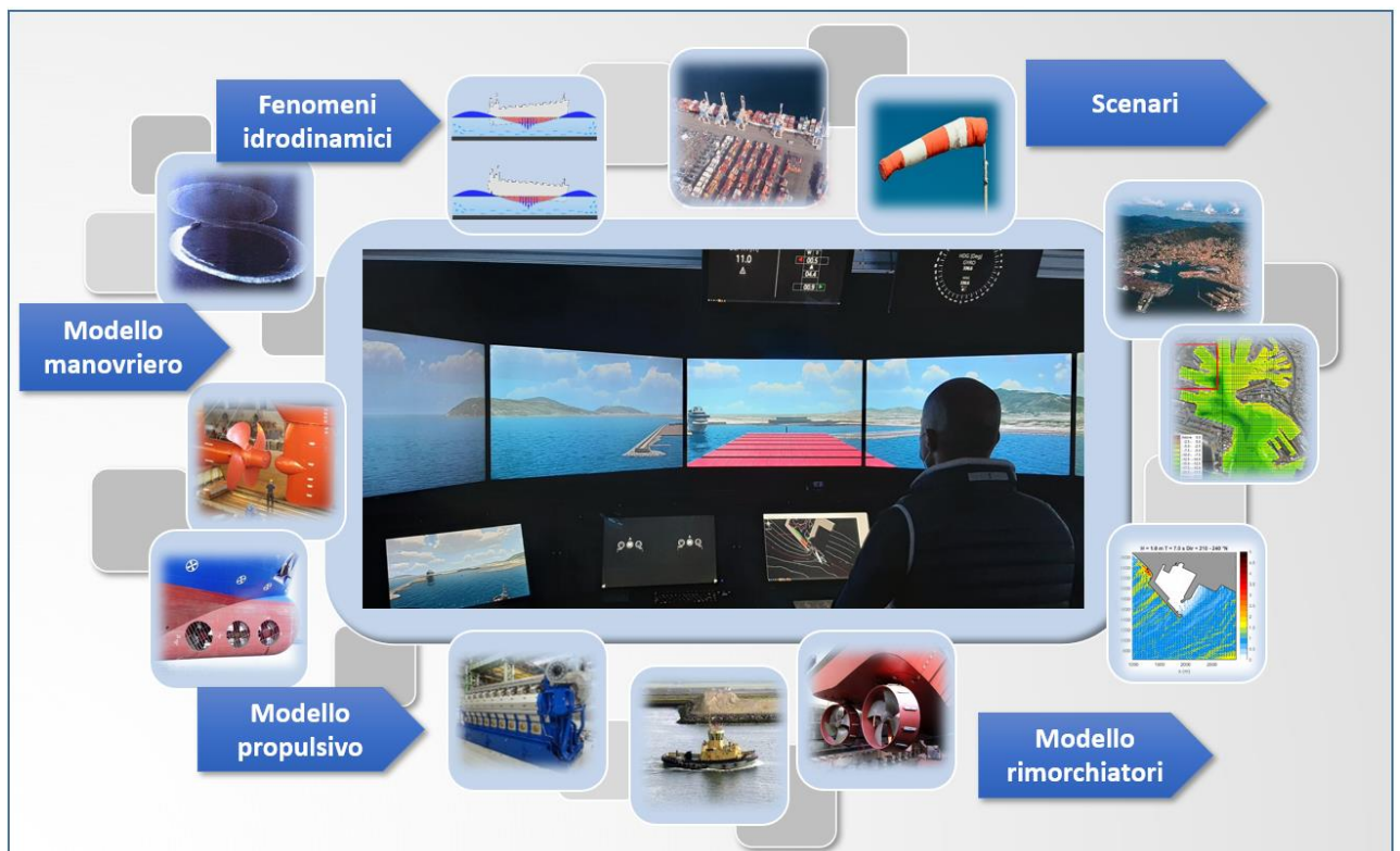
Fig. 2-1 Principali blocchi del modello matematico del simulatore
