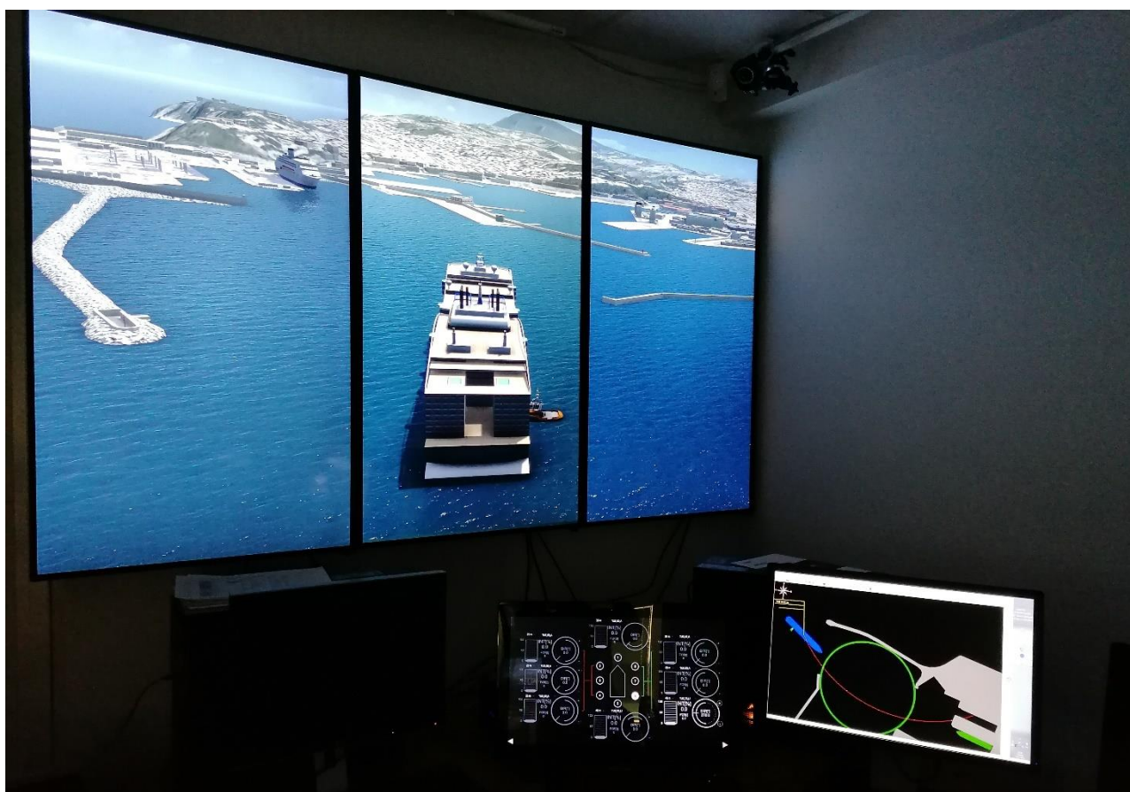
Fig. 4-1 Simulatore MANTA – Durante le prove i rimorchiatori sono stati comandati tramite un touch screen dedicato.
