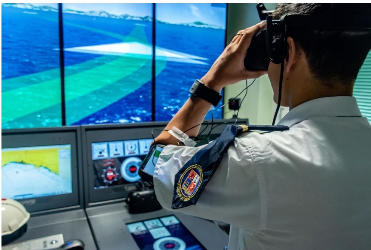
Fig. 2-3 Simulatore di manovra – Postazione con visore HMD 3D dedicato alla visuale dalle alette
