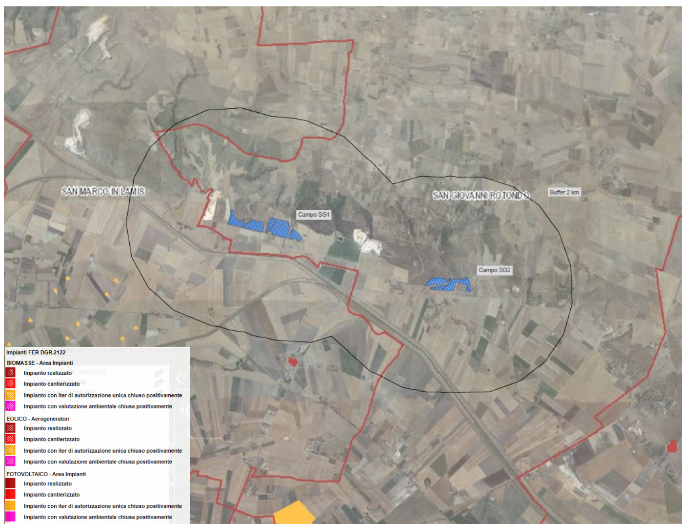
Figura 3 – Impianti FER in un raggio di 2 km dalle recinzioni di progetto
