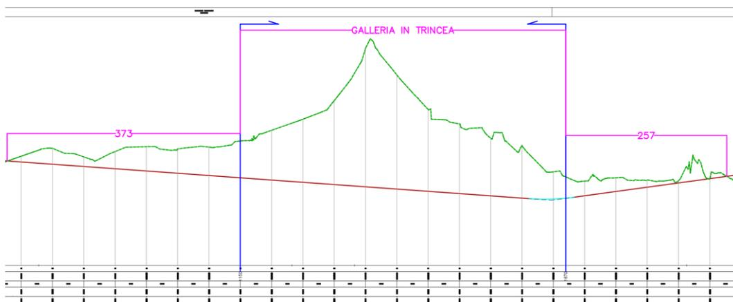
**Figura 5 - Estratto del profilo longitudinale del tracciato ferroviario; in magenta i due tratti in trincea all'ingresso e all'uscita del tunnel considerati ai fini del dimensionamento delle vasche di accumulo.**
